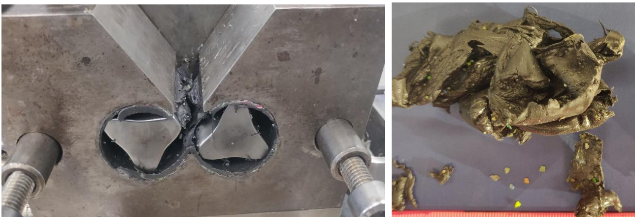
Figura 2. Izquierda: detalle de los rotors y cámara de mezclado, Derecha: material tras el mezclado. Divisiones en milímetros.
